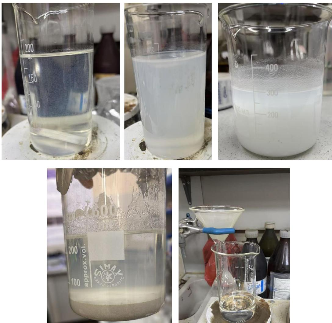
Рисунок 5 - Силикатный раствор, содержащий диоксид кремния в растворённой форме в виде ортосиликат-ионов и других силикатных комплексов.
